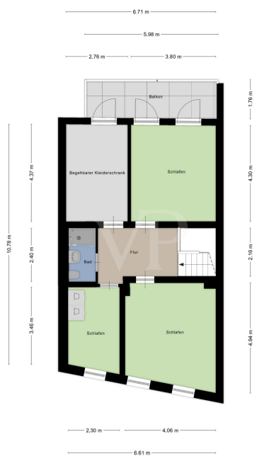
Aufmass und Grundriss erstellt von Zibber ©
